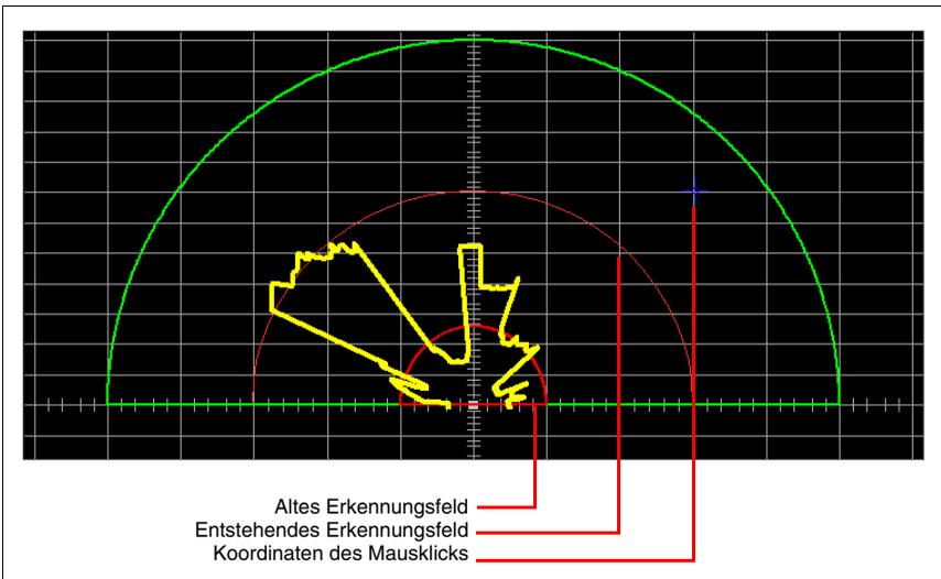
Bild 6.7: Erkennungsfeld "Ellipse" positionieren
