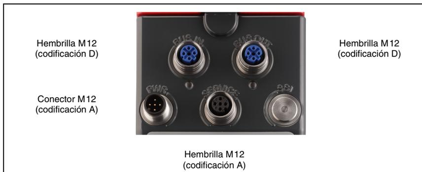
Figura 9.4: Conexiones del AMS 348*i*
