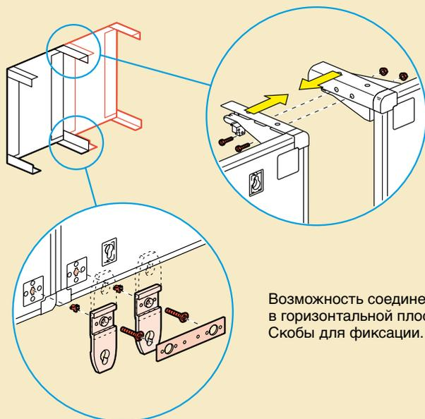
Возможность соединения в горизонтальной плоскости. Скобы для фиксации.
