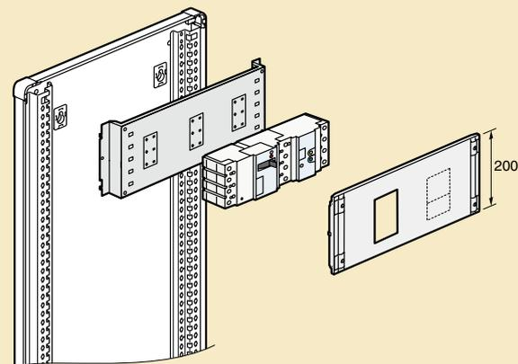
Для выключателя DPX-IS и DPX, вертикальный монтаж в шкафу
