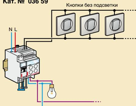
Дистанционно управляемый светорегулятор 600 ВА для люминесцентных ламп
