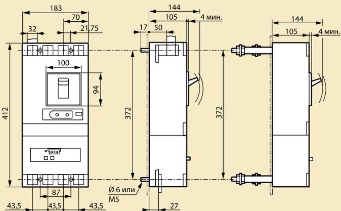
**Съемное исполнение, подключение сзади**
