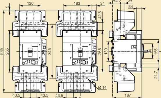
**Выкатное исполнение, подключение сзади**
