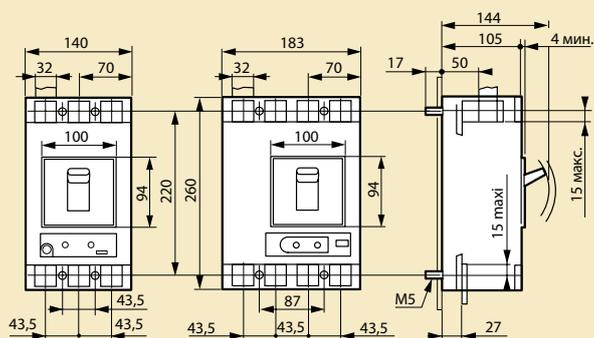
**Фиксированное исполнение, блок УЗО снизу**
