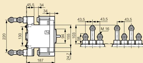
Подключение плоскими клеммами
