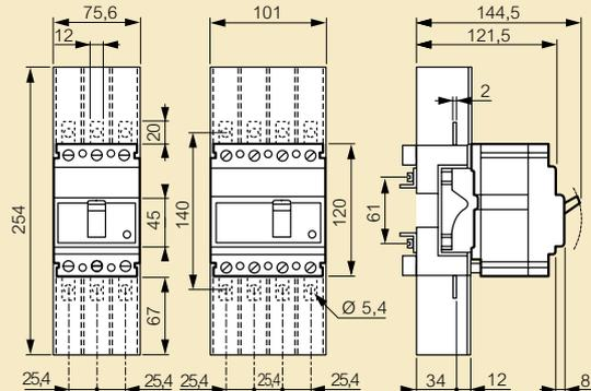
**Съемное исполнение, подключение сзади**
