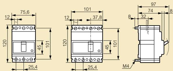
**Стационарное исполнение, подключение сзади**
