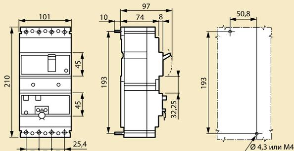
**Фиксированное исполнение, подключение сзади, блок дифференциальной защиты снизу<sup>(1)</sup>**
