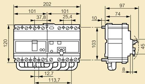
**Фиксированное исполнение, подключение спереди, блок дифференциальной защиты снизу<sup>(1)</sup>**
