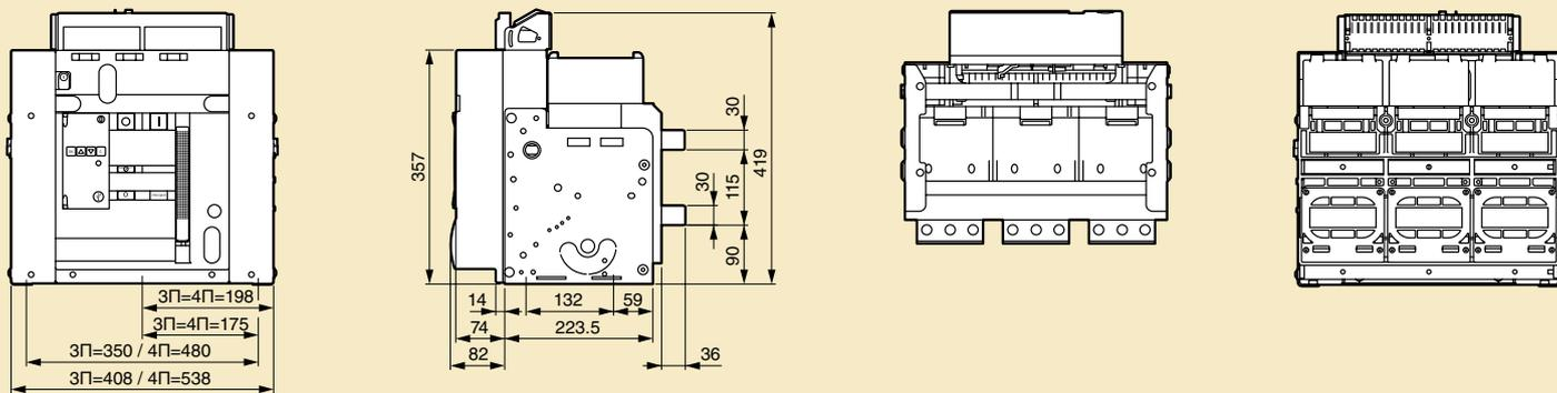
**Задние клеммы фиксированного аппарата**
