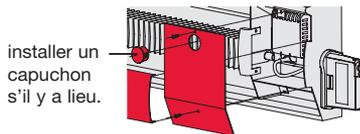
**6 Remettre le couvercle de la plinthe.** (Si un thermostat était intégré dans la plinthe, installer un capuchon pour boucher le trou.) Mettre la plinthe sous tension. Ne pas mettre le couvercle du module d'antenne.
