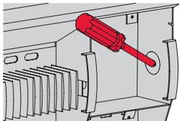
**1** Enlever l'entrée défonçable sur le côté de la plinthe.
