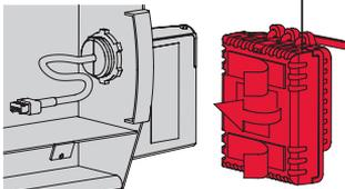
**3** Nettoyer le panneau arrière à l'intérieur du compartiment de câblage où le relais sera installé. Décoller la bande adhésive du relais et installer le relais sur le panneau arrière.
