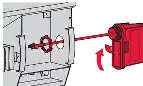
**2** Retirer l'écrou de l'antenne et décoller la bande adhésive. Passer le fil de l'antenne à travers l'ouverture et installer l'antenne à la verticale tel qu'illustré. Remettre l'écrou et le serrer.
