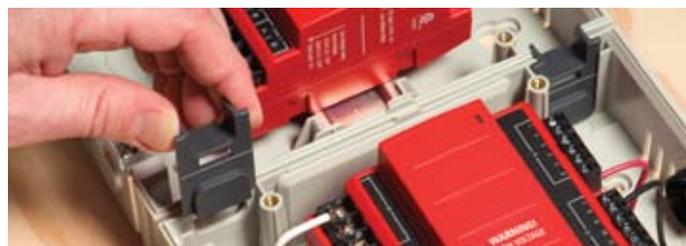
Les connecteurs de voies pratiques permettent d'ajouter une zone sans avoir à faire passer des fils à l'extérieur des panneaux. On élimine ainsi le risque d'exposer des fils à l'extérieur du panneau, dans la maison du propriétaire, et on obtient ainsi une installation propre et bien organisée.
