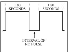
PULSE WIDTH MODULATION SIGNAL OF A 2/3 ACTUATOR POSITION
