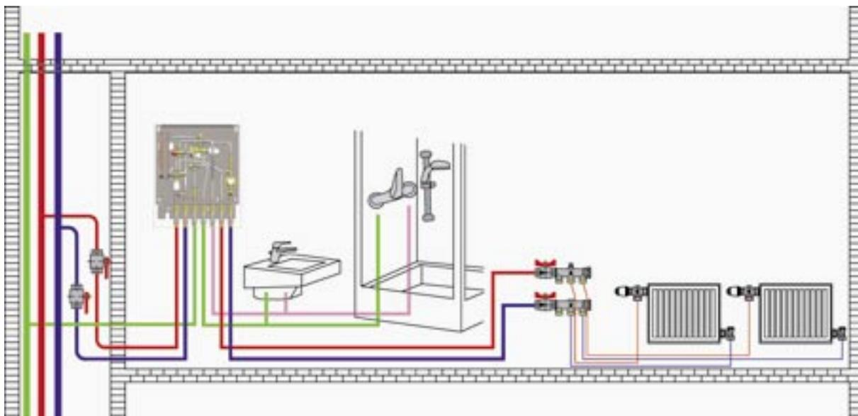
Нагревательный модуль ГЕРЦ подключается к сети централизованного теплоснабжения параллельно. По возможности необходимо подключить нагревательный модуль еще до первого потребителя по отоплению.
