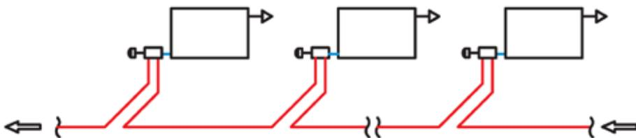
Возможные схемы разводки системы отопления с использованием узла ГЕРЦ-VTA.
