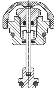
Для регулировки термостатических букв могут применяться все термоголовки ГЕРЦ с дистанционным управлением, а также компоненты электронной регулирующей системы ГЕРЦ-RTC (электронный регулятор температуры, приводы DDC) и ГЕРЦ-RTR (комнатные термостаты, термомоторы).
