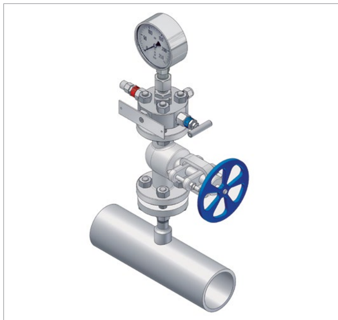
Tuyauterie horizontale, sortie axiale
