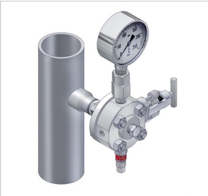
Tubería Horizontal, Salida Axial
