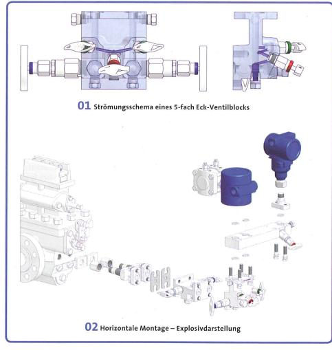
das System unempfindlich gegen Schwingungen. Der Anwender kann auf zusätzliche Leitungen oder Ventile verzichten und erhält damit eine kompakte, übersichtliche und robuste Armatur - die zudem noch einfach, schnell und kostengünstig zu installieren ist.
