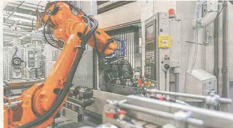
Bei der Armaturenfabrik Franz Schneider in Nordheim werden solche Doppelspindelmaschinen in der Produktion eingesetzt.
