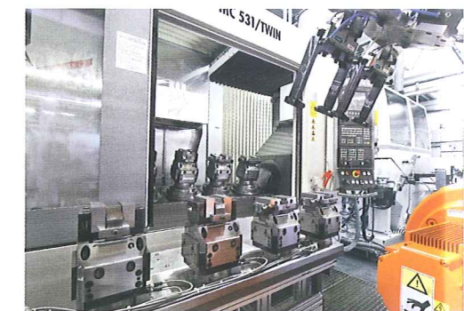
Rüststation: Der Roboter belädt die Tandem-plus-Kraftspannblöcke außerhalb der Maschine und wechselt sie in gespanntem Zustand ein.
