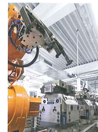
Prozessstabile Werkstückspannung mit den federgespannten Kraftspannblöcken Tandem KSF plus.
