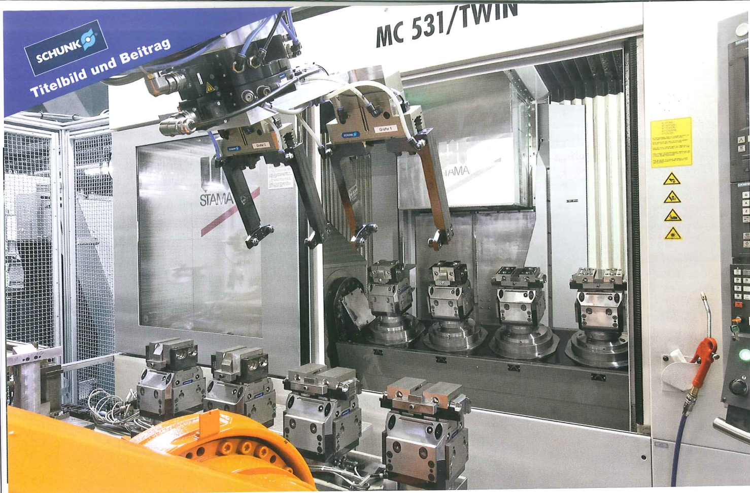
Automatisierte Beladung: Beim automatisierten Spannittelwechsel spielt die Leistungsfähigkeit der Nullpunktspannsysteme eine entscheidende Rolle.
