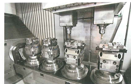
Bearbeitung: Auf den Drehsatelliten werden die Tandem plus Kraftspannblöcke jeweils einzeln in einem Vero-S-Modul gespannt. Auch wenn keine Druckluft anliegt, gewährleisten die Tandem plus eine sichere Werkstückspannung.
