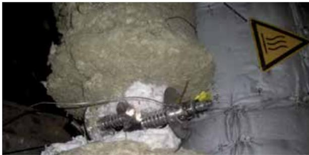
AS-Schneider Doppel-Absperrventil eingebaut in Versuchsanlage COMTES700 für einen Langzeit-Designtest bei 700 Grad Celsius (Isolierung entfernt)
