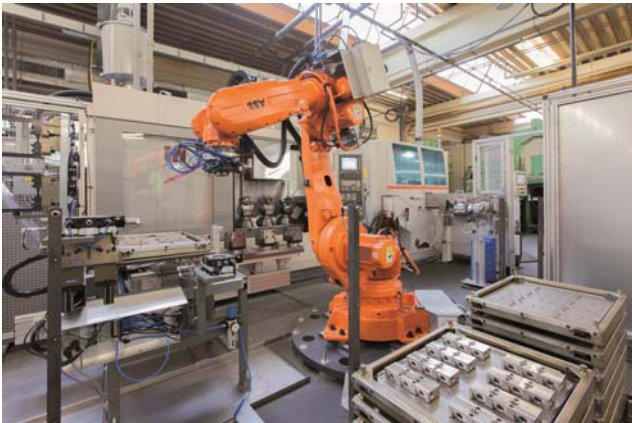
Neue Fertigungszelle: Doppelspindelmaschine und Kaltkreissäge
