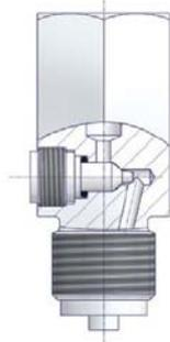
**Bild 2:** Der Stoßminderer reduziert die Druckspitzen, die etwa durch schnelles Schließen einer Absperrarmatur auftreten können.
