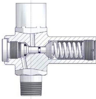
**Bild 1:** Die Überdruckschutzvorrichtung ist für stetig ansteigenden und andauernden Überdruck konzipiert.
