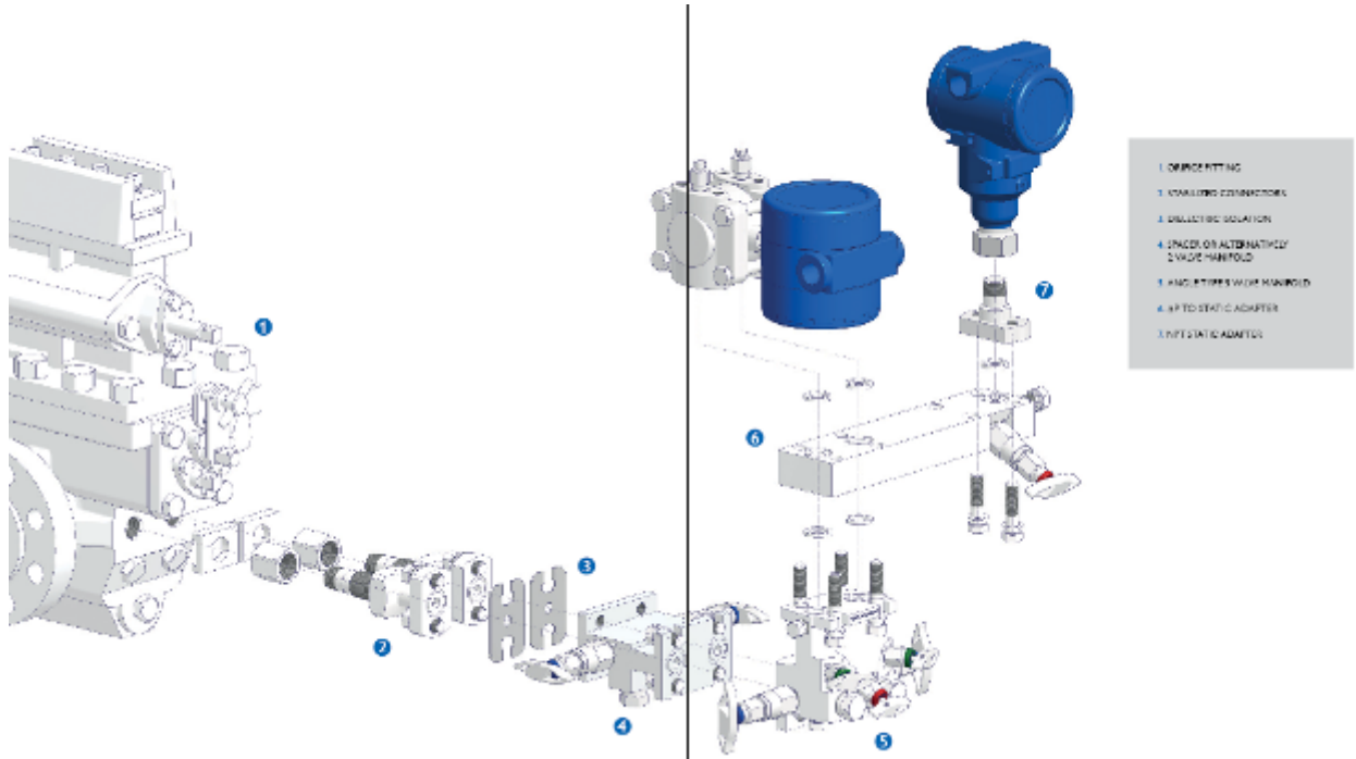
Bild 4: Horizontale Montage - Explosivdarstellung. Siehe PDF-Datei.
