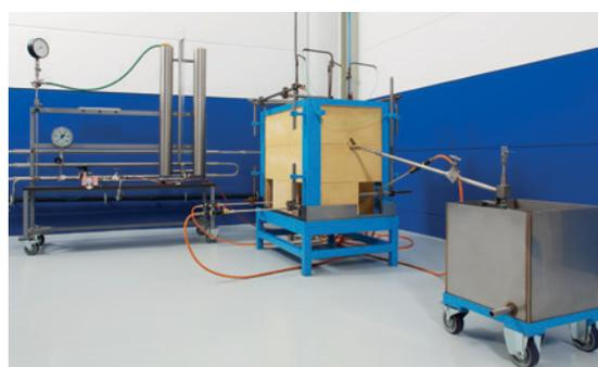
**Fire Safe Prüfstand**
