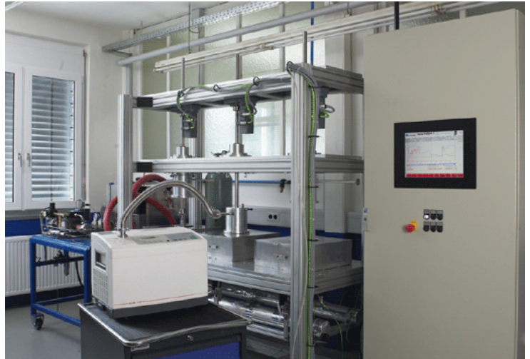
Abb.: AS-Schneider Armaturenprüfstand
