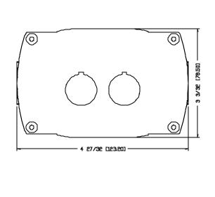
800F-2PP 2 HOLE PLASTIC ENCLOSURE WITH PG THREAD
